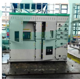
圖 18：IS-24 智能配電盤安裝於振動台上側面全圖
