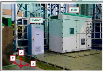
圖 7：IS-66 及 IS-66-T 安裝於振動台上側面全圖
