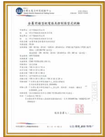
CNS 15156-200及IEC 62271-200 型式試驗合格報告 (包含故障電弧、短路性能、絕緣性能)
